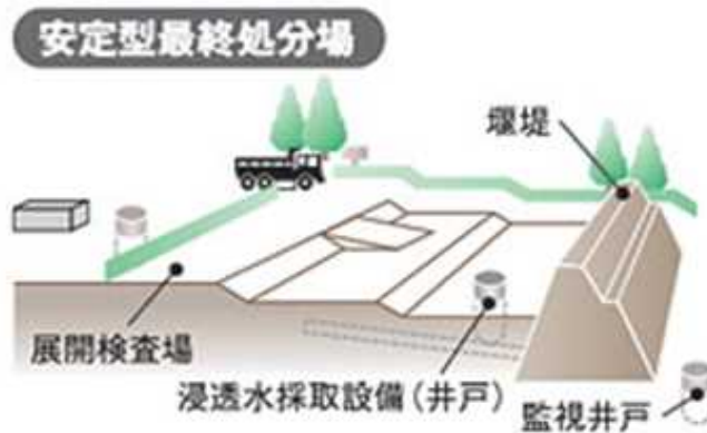
図XIV 地下水汚染の懸念がない場合の除去土壌及び廃棄物の最終処分施設イメージ
